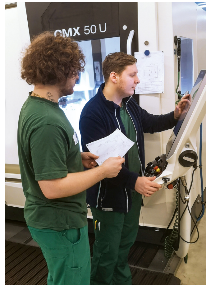
Zwei Auszubildende aus dem 3. Lehrjahr programmieren ein Teil für die Produktion an einer CNC-Fräsmaschine
