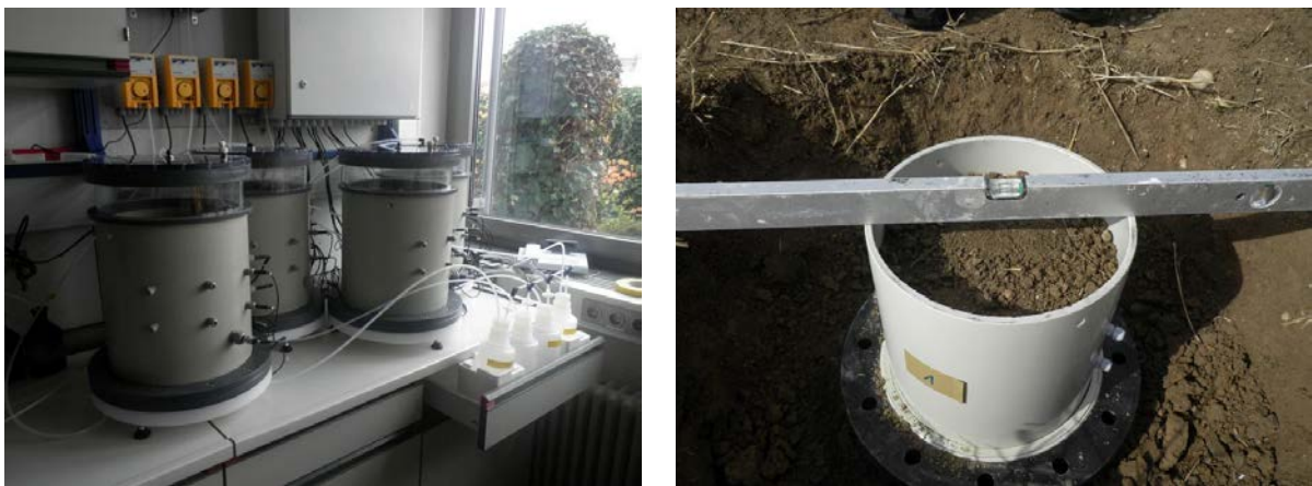
Bild 2.7: Laborlysimeteranlage und Entnahme der ungestörten Bodenproben in einem Testgebiet
