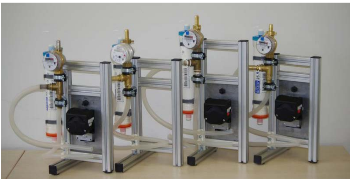
Bild 2.16: Praxistaugliches System zur Vor-Ort-Anreicherung von coliformen Bakterien und Enterokokken
