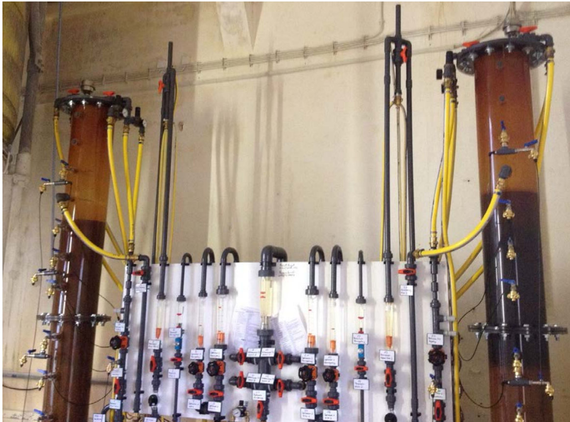
Bild 2.4: Halbtechnische Versuche zur Enteisung
