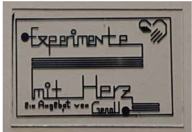
Eine exemplarische Leiterplatte mit einer Kantenlänge von nur 39 mm Länge und 25 mm Breite, wie sie bei „Experimente mit Herz“ im MicroLab von den Teilnehmenden hergestellt wird. (Bild: H.-J. Wuthenow)
